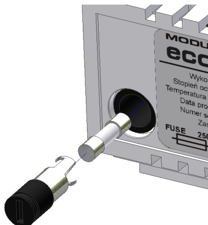
Rys. 7.1 wymiana bezpiecznika w module Lambda Control
