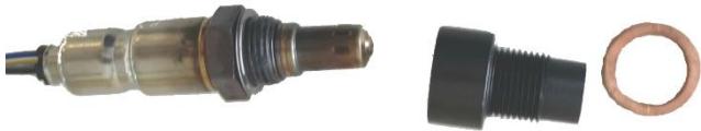
Rys. 6.3 Zalecana osłona sondy lambda od oparów sadzy poprzez gwintowaną tuleję i pierścień
